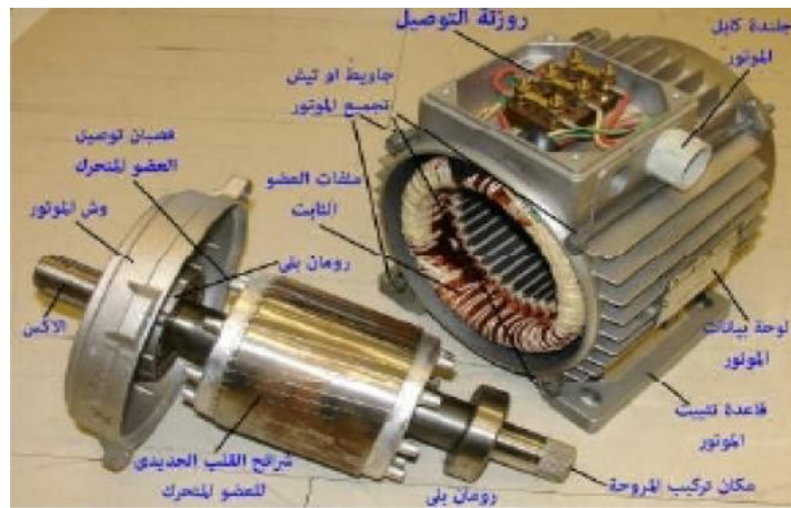
شكل ٢-٦ إجمالي المحرك التاثيري ذو القفص السنجاي من الداخل
