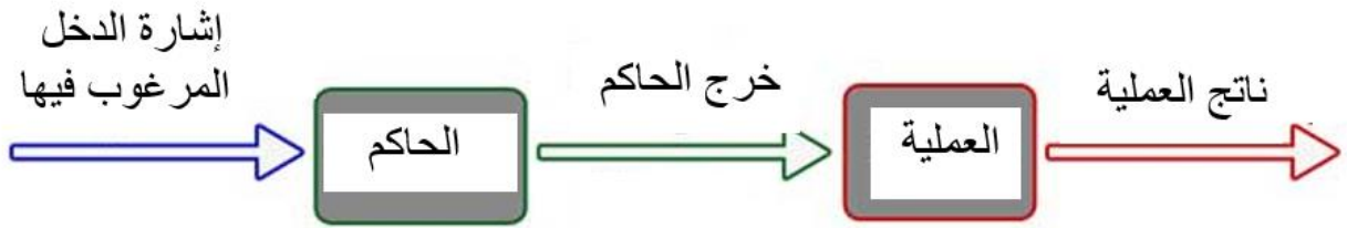
شكل ١-٥ مخطط الكتلة لنظام التحكم ذو المسار المفتوح
