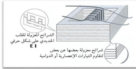
شكل ٢٠-١ ملفات ملفوفة حول قلب حديدي مقسم لشرائح
