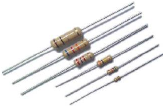
شكل ١-١٤ تساوى قيم المقاومة الاومية بالرغم من اختلاف قدرتها
