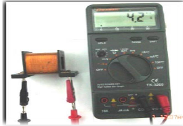
شكل ٢٧-١ استخدام الافوميتر للتحقق من سلامة الملف
