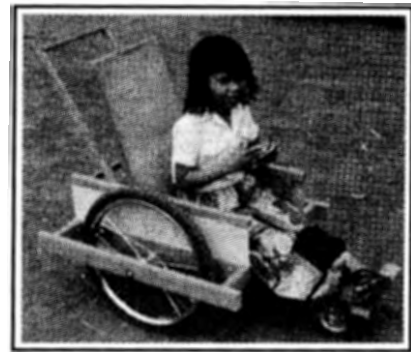
كرسي متحرك خشبي في تايلندة: محورا إطار الدراجة مدعومان من الجانبين لمنعها من الانثناء.
