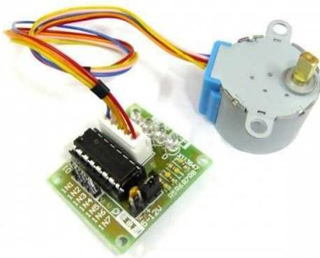
محرك الخطوة هو أحد أنواع المحركات الكهربائية الميكانيكية . ولعله الأدق من ناحية التحكم بالسرعة و زاوية الوقف . محركات الخطوة لها تركيب و نظرية عمل تختلف عن المحركات السابقة و يكون معها عادة دائرة تحكم لتكبير التيار اللازم للتشغيل .
