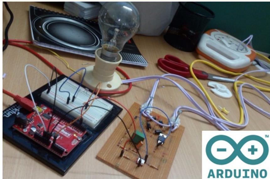
كما ذكرنا فالأردوينو يعمل على إصدار إشارات كهربائية على أطرافه. لكن هذه الأطراف لها قدرة كهربائية محدودة. يمكنك تشغيل ضوء بسيط LED من الطاقة الصادرة من الأردوينو ، لكنك بالتأكيد لن تتمكن من تشغيل محرك بهذه الطاقة البسيطة ( 5v و حوالي 40mA ) لذا فكثيراً ما نحتاج لدوائر التكبير.
